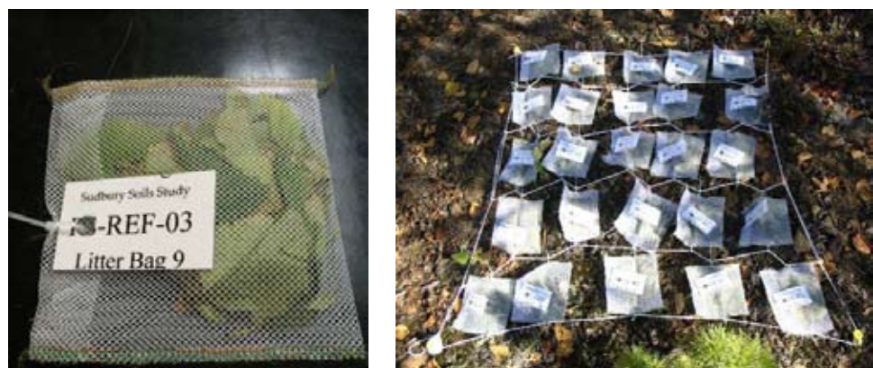
Figure 3-12 : Sacs à déchets pour l'évaluation de la décomposition : a) feuilles de bouleau dans un sac à déchets en tulle de nylon; et b) sacs à déchets recouvrant la surface de la forêt.
